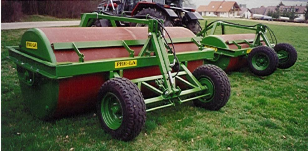
Abb. Fahrbare Walzen einteilig mit Radbremse Walzen-Ø 1,22 m und 1,045 m
